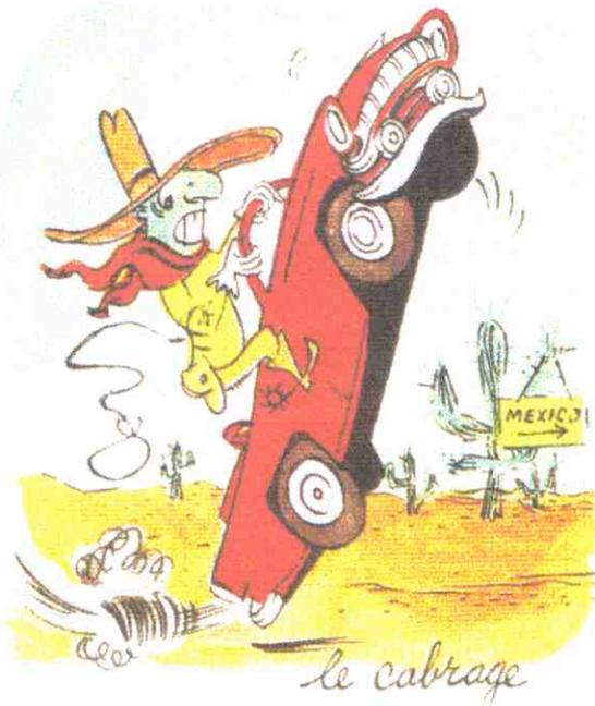
SI, pour être agréable, la suspension est trop élastique et qu'on démarre vigoureusement avec toute la puissance du moteur, la voiture va bondir, elle va se cabrer comme un cheval aiguillonné par l'éperon. Elle restera cabrée tant que l'on continuera à accélérer; il faut refreiner ce **CABRAGE** comme on maîtrise un pur-sang.
