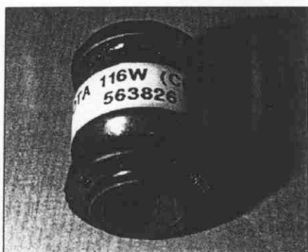
Ces articulations équipent le train arrière de la Toyota Corolla.
