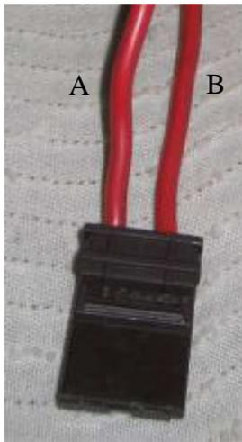
Préparer la prise PM2 en coupant à environ 15 cm les deux fils rouge puis en soudant à l'extrémité du fil « A » une cosse femelle (qui se branchera sur le relais) :
