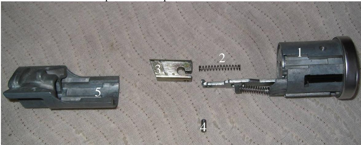
Placer la pièce 1 verticalement et y positionner le bloc contacteur (s'assurer du bon positionnement du cylindre, face à l'orifice de commande de la clé).
