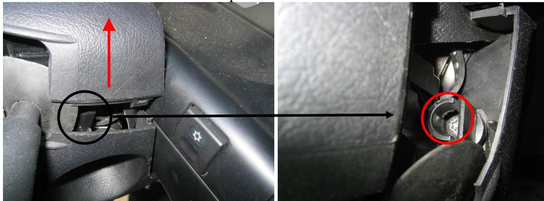
Dégager la coque inférieure en tirant vers l'avant et le haut (débloquer préalablement la manette de réglage du volant), puis débrancher le rhéostat d'éclairage du tableau de bord
