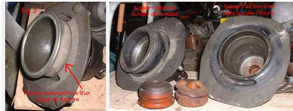
Le changement des supports est aisé (fig 4), compter environ 1H30. Matériel nécessaire : cric, chandelles, clé à cliquet (+ rallonge pour le manche), douille de 12,13,16,22, clé plate de 9 et
